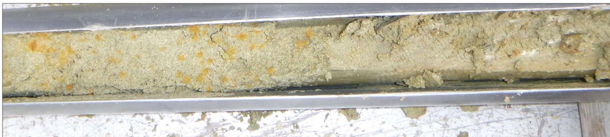
Bild 3: Schicht 3 / Sand-Schluff-Gemisch in der Bohrsonde RKS 2
