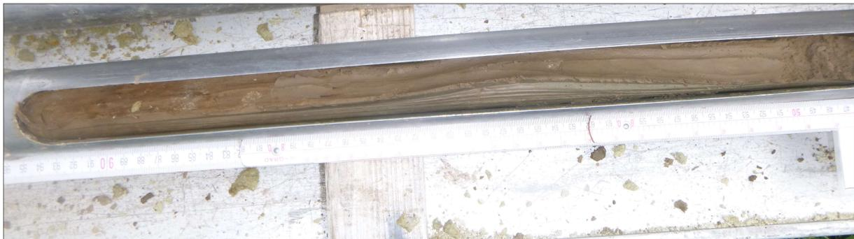
Bild 2: Schicht 2 / Lößlehm in der Bohrsonde RKS 2
